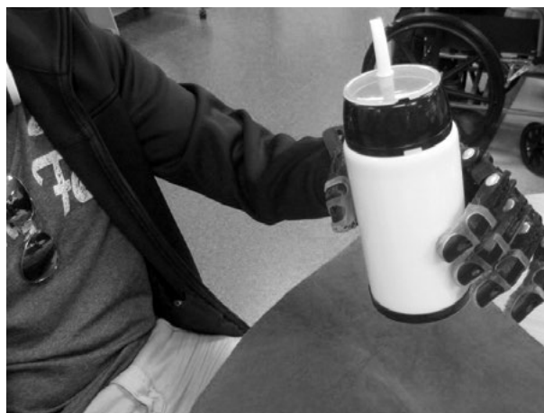
Imagen 15: Prótesis en impresión 3D para amputación transmetacarpiana
