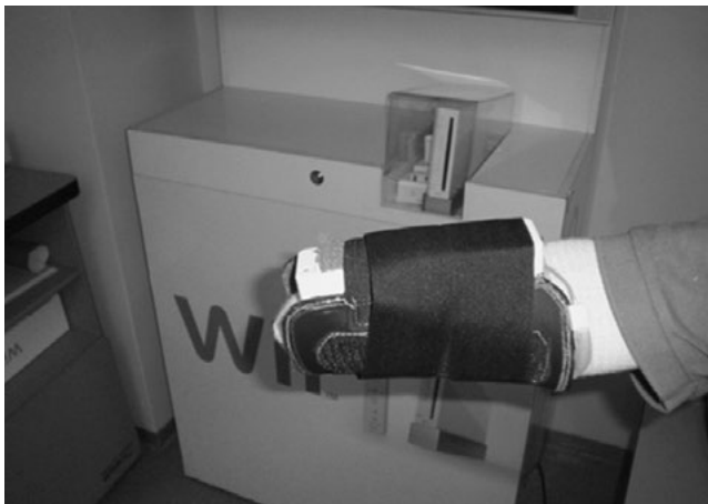
Imagen 4: Adaptación para sujeción de control de consola
